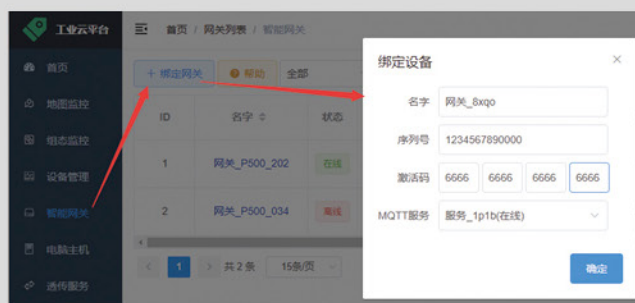
云平台用户绑定 PLC 设备
